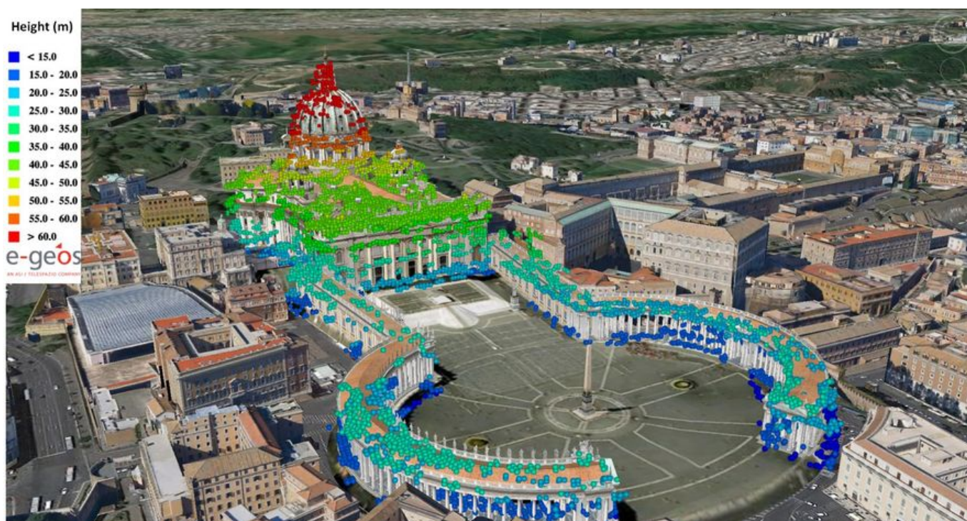
Przykład wykorzystania danych pochodzących z satelity SAR systemu Cosmo-SkyMed do opracowania modelu wysokości budynku. Tu na przykładzie bazyliki Św. Piotra w Watykanie. Fot. E-GEOS/ESA
