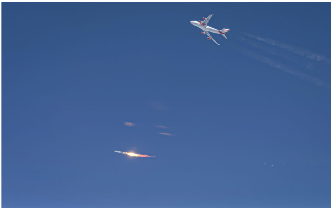
Moment pierwszego odpalenia silnika rakiety LauncherOne w czasie testu 25 maja 2020 roku. Fot. Virgin Orbit [virginorbit.com]
