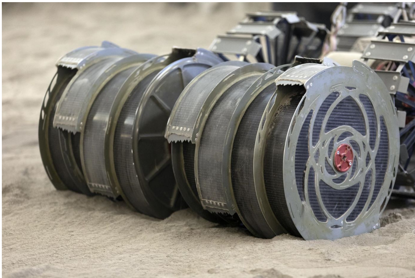
Mechanizm kopiąco-pobierający eksperymentalnego robota księżycowego NASA RASSOR (Regolith Advanced Surface Systems Operations Robot), przeznaczonego do wydobywania użytecznych ilości regolitu na Srebrnym Globie. Fot. NASA/Kim Shiflett [nasa.gov]
