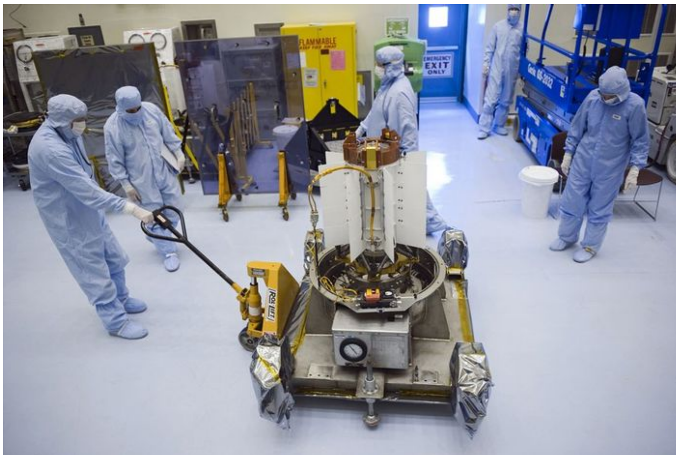
Multi-Mission Radioisotope Thermoelectric Generator (MMRTG) - takie urządzenie zasila łązik Curiosity na Marsie. Fot. NASA
