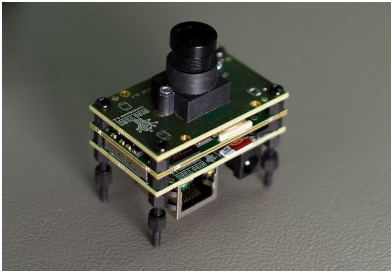
Miniaturowa modułowa kamera cyfrowa o wszechstronnym zastosowaniu. Fot. Creotech Instruments
